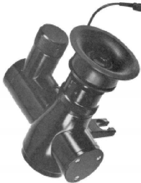
**Figura 21.39 – Diagrama do Dispositivo de Bolha para Adaptação em Sextante Náutico**
